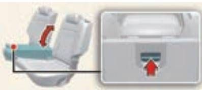
Jei norite sulenkti centrinę sėdynę atskirai, paspauskite sėdynės sulenkimo svirtelę ant centrinės sėdynės atlošo.
