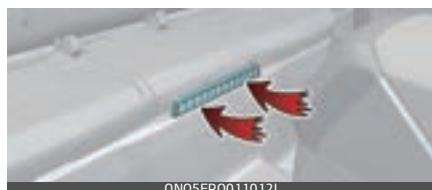
Hibridinio akumulatoriaus aušinimo kanalas yra po galinėmis sédynėmis. Aušinimo kanalas aušina hibridinj akumulatorių. Užblokovus hibridinio akumulatoriaus aušinimo kanalą hibridinis akumulatorius gali perkaisti.
